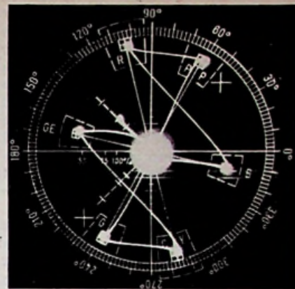
Afb. 17. Oscillogram van een vectoriële voorstelling van een kleur-balkentoetsignaal op de vectorscoop (100 % / 100 %).
